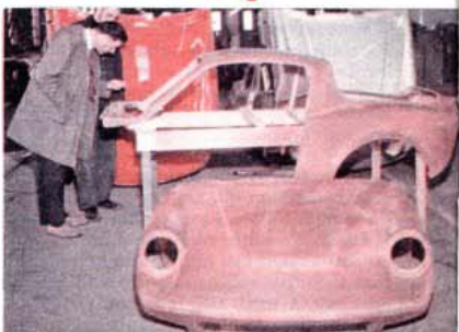
Framför ett par färdiga Sonetter synar Björn Andreasson och en av montörerna vid bandet ett karosskal. Ytfinishen är utmärkt.
