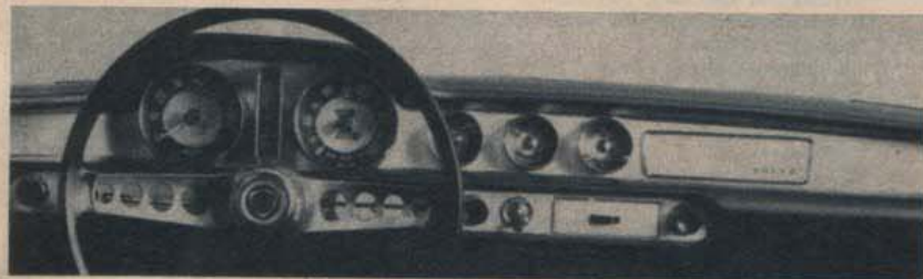
Ändrad gradering på varvräknaren. Särskild markering för 50 km/h finns på P 1800 S instrumentbräda.
