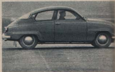
Saab 96. 5-sitsig, 2-dörrars. 3-cyl. tvötaktsmotor på 42 SAE hk. Toppfart 125 km/t. Gick i fjol upp som den mest köpta svenska modellen — 22.680 ex.
