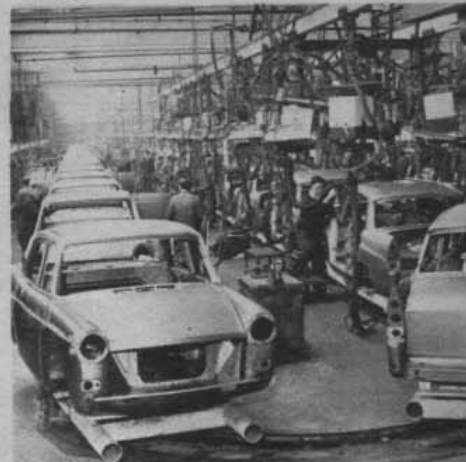
Pressed Steel's press- och monteringshallar är rejält tilltagna. Automationen är långt driven och yrkesskickligheten stor. Här är en ny serie Morris Oxford på väg till lackeringsavdelningen.
