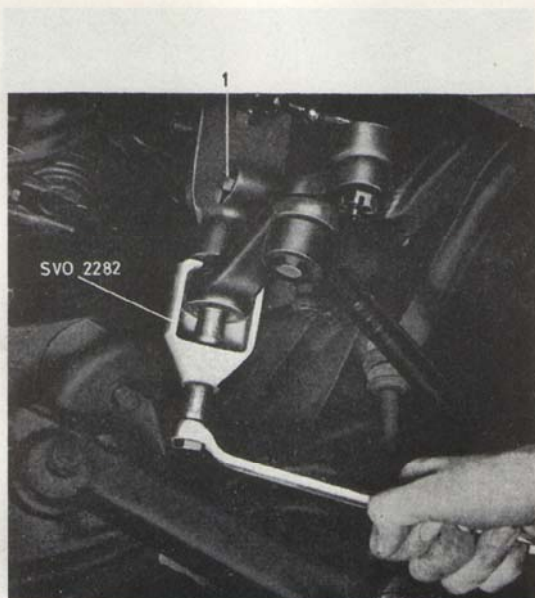
Bild 13. Demontering av pitmanarm.
