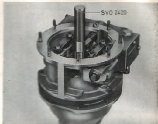
Bild 28. Montering av främre hushalva
