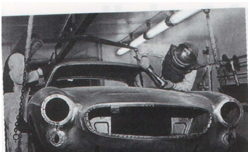
Kaross-svetsning på Pressed Steel Inc. Skottland.
